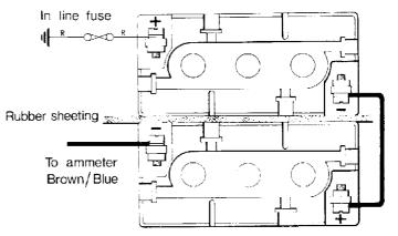
Fig. 54 Two 6 volt batteries connected for 12 volt operation
