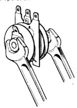
Fig. 37 Silicon diode rectifier
